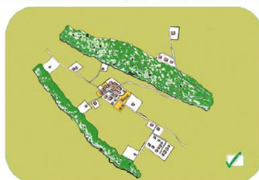
À PRIVILÉGIER : optimisation foncière et bâtie (dents creuses, divisions parcellaires, réhabilitations)
